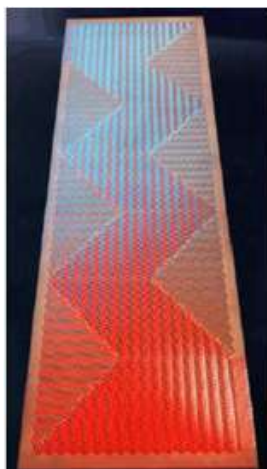
Hình H-2.37A- Cấu tạo của một bản hợp kim đã được khắc rãnh bằng máy khắc quang hóa
