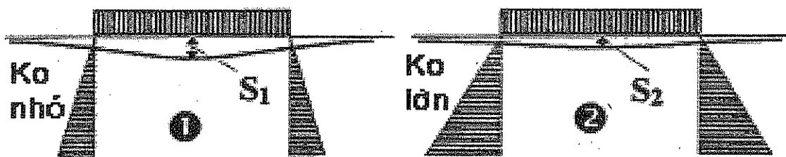
Hình 4.12. Ảnh hưởng của áp lực ngang ( \sigma'_h = K_0\sigma'_v ) đến độ lún
