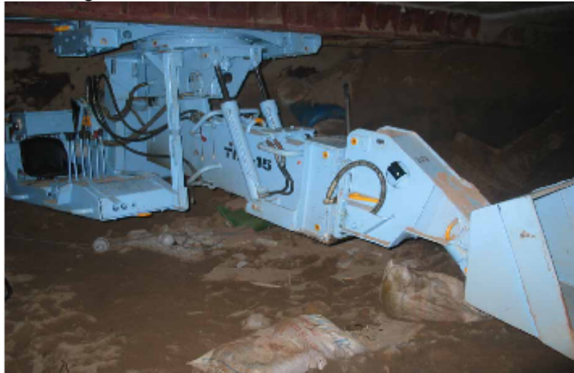
Máy xúc lật chạy trên trần của khoang làm việc ( ảnh lấy từ Workshop Baichay Bridge)
