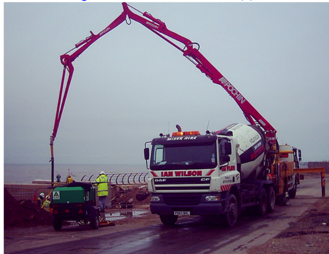
Hình 2.29- Xe bơm bê tông, cần bơm có thể vươn xa(a) và vươn cao đến 20m (b).
