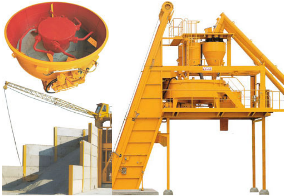
Hình 2.22 b- Trạm trộn bê tông trên công trường.
