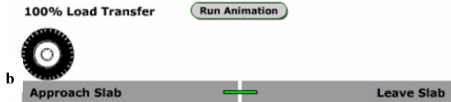
Hình 3.29 : Tải trọng xe truyền qua giữa các tấm BTXM
