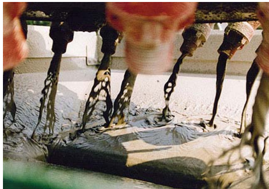
Hình 5.6. Bùn khoan được tách khỏi dung dịch
