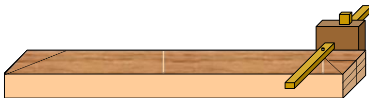
Hình 7.4: Sử dụng cữ vạch để vạch dấu bề rộng thân mộng mũi.
