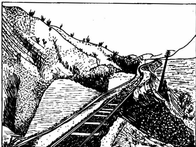
Hình 1.4. Trượt sườn (tuyến đường sắt Hà Lào)
